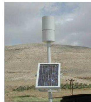
Panneau solaire et pluviomètre protégés contre le vol et le vandalisme
