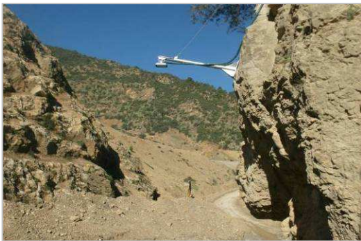
Radar installé sur la falaise du Rocher des Pigeons par des travaux acrobatiques
