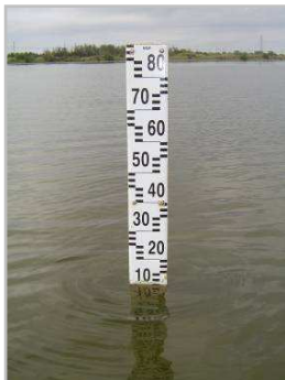
Echelle limnimétrique ancrée au fond de l'étang
